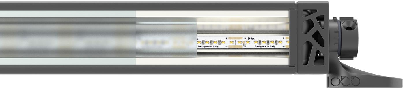
Apparecchio con ottiche lineari a plafone e/o in appoggio per illuminazione a LED per ambienti interni. Utilizza le nostre ottiche simmetriche Low Contrast, asimmetriche Wall Washer e Ceiling Washer. Le ottiche sono in alluminio Miro Silver con altissimo rendimento >98%. Sono previste micro alette all'interno delle ottiche al di sotto del diffusore.
